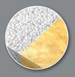
Unter dem Begriff "gedämmte Wände" sind Wände aus Mauerwerk, Beton und Holz zu verstehen, auf die direkt eine Dämmung z. B. aus Polystyrol, Mineralwolle, Steinwolle oder Holzfaserplatten etc. aufgebracht wurde.
